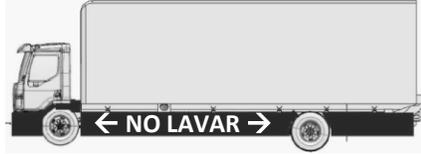
Evite mojar cualquier parte del chasis, especialmente las áreas donde se alojan los sistemas de baterías y los cables.
